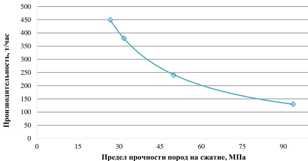
**Рисунок 2.14** – Зависимость производительности фрезерного комбайна от прочностных свойств пород
