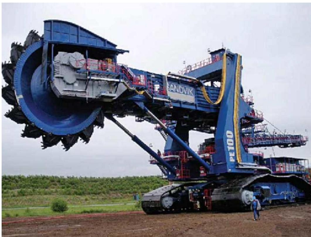
**Рисунок 1.7** – Компактный роторный экскаватор компании «Sandvik Mining and Construction» [50]
