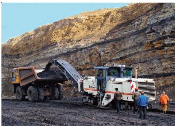
**Рисунок 1.12** – Безвзрывная технология с использованием комбайнов 4200 SM (а) и 2200 SM (б) с погрузкой полезного ископаемого в автосамосвал БЕЛАЗ грузоподъемностью 55 т.
