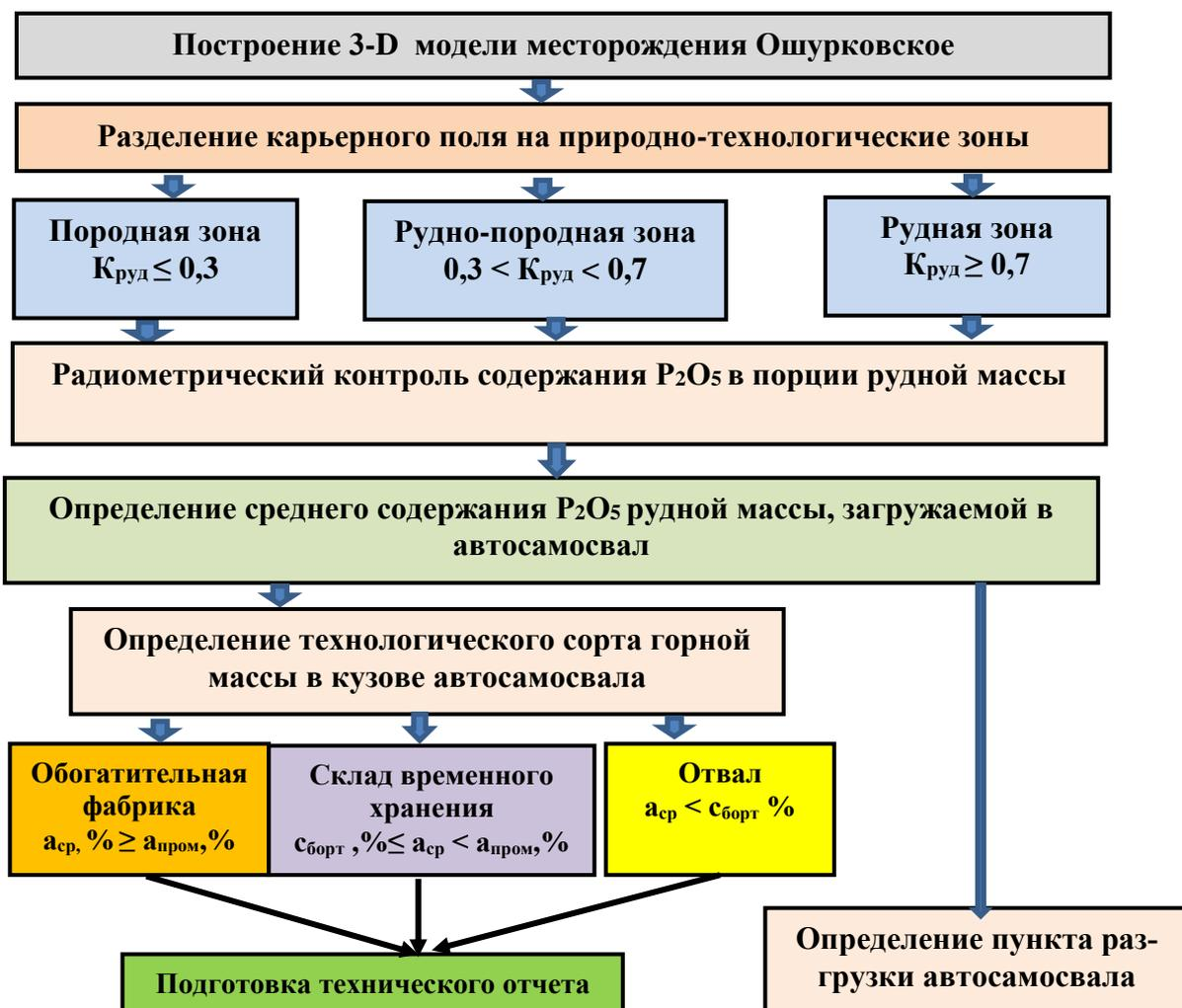
**Рисунок 3.17** – Схема формирования грузопотоков с заданными качественными характеристиками при разработке месторождения Ошурковское
