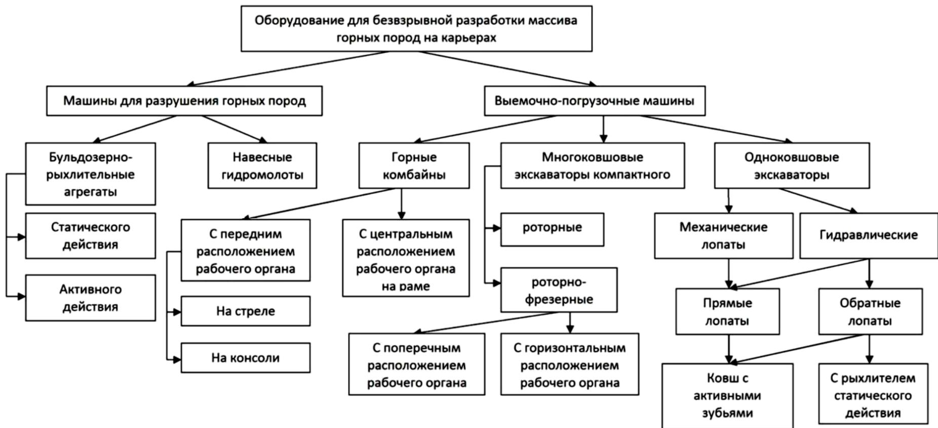
Рисунок 1.4 – Типы оборудования, применяемые для безвзрывной разработки массива горных пород на карьерах [32]
